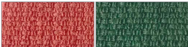
Obrázek 3: Obarvený vláknenný substrát len olejný / biopolyamid 6.10 Vestamid Terra HS
